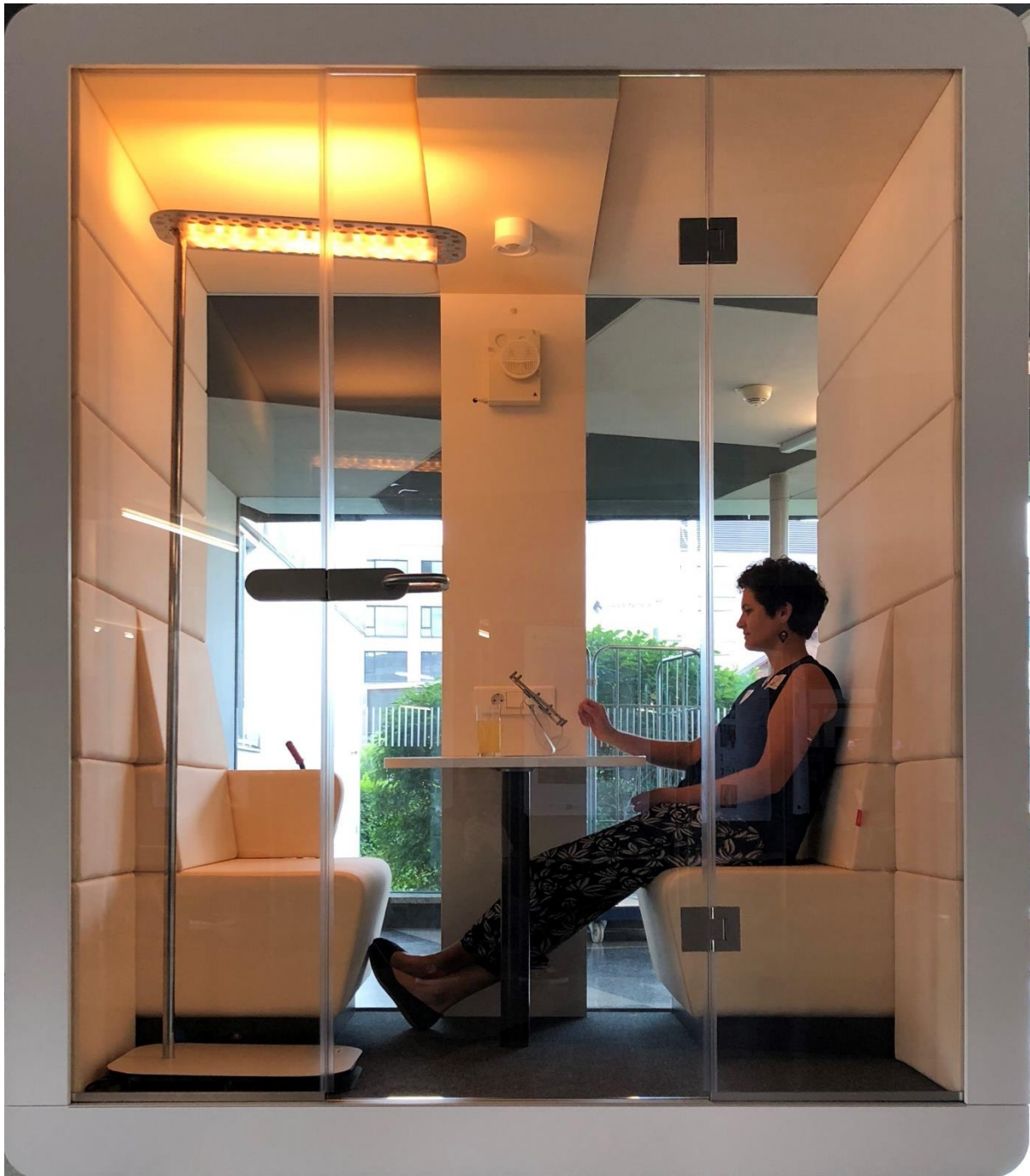
Abbildung 1: Testsetting mit Leuchte (links), Duftmodul (oben), Tablet (mittig) und Lautsprecher (versteckt in der Decke der Kabine)
