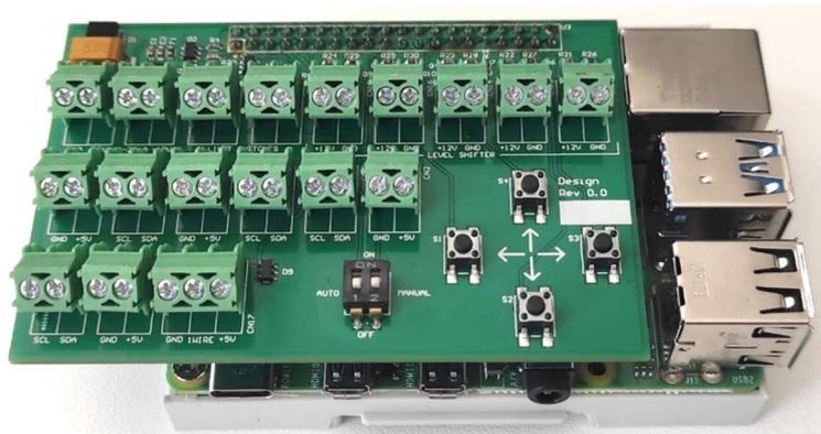
Abbildung 1. Entwickelte Steckplatine für den Raspberry Pi
