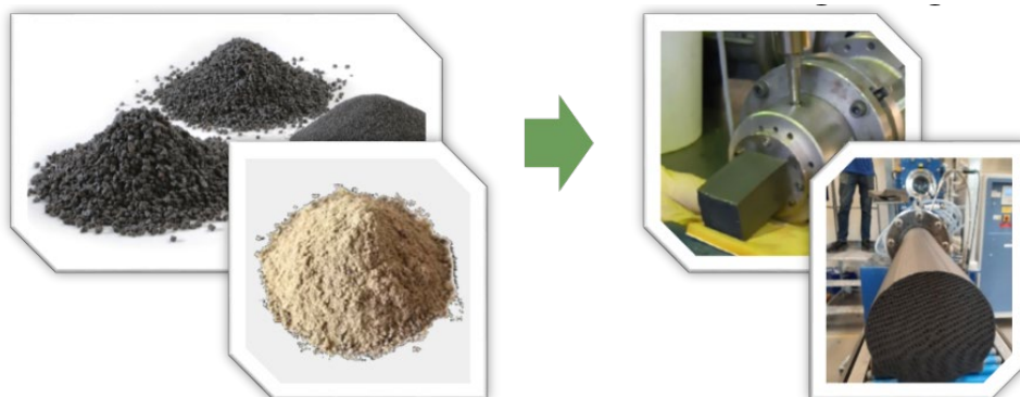
Figure 3. Rohmaterialien bestehend aus Grundkeramik und Zuschlagstoffen (li), Formgebung durch Extrusion (re).
