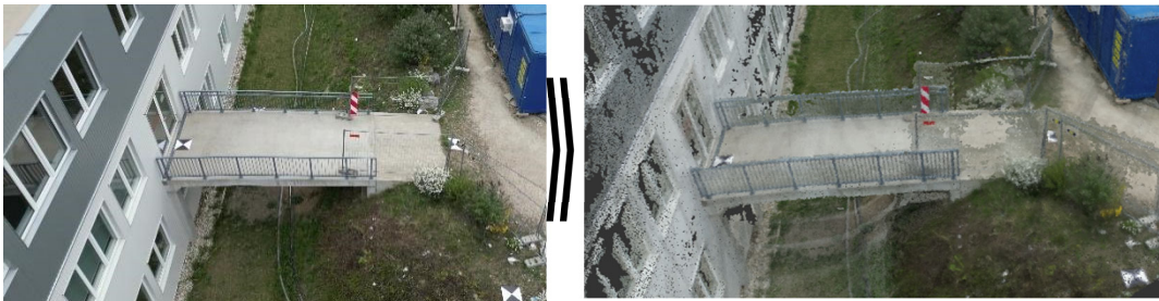
Abbildung 2. Prozessschritte von der Drohnenaufnahme zur Punktwolke am Beispiel der Pavillionbrücke - FH Campus Wien
