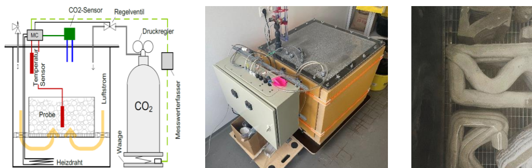
Abbildung 1. Schematische Darstellung des Versuchsaufbaus zur beschleunigten Karbonatisierung von Beton (li.), Überblick über die Prüfkammer und die Steuerung (Mitte) und die 3D gedruckten Proben während dem Versuch (re.).
