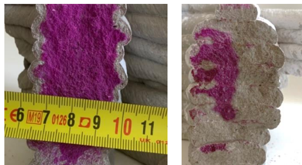
Abbildung 2. 3D gedruckter Querschnitt nach der CO 2 -Lagerung für 12 h (li.) und bei Beendigung des Versuchs nach 42 h (re.).
