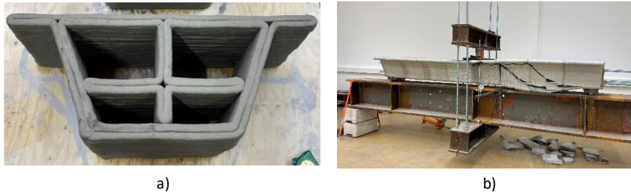
Abbildung 1: a) Additiv gefertigtes Hohlkastensegment; b) Prüfung der vorgespannten Hohlkastensegmente
