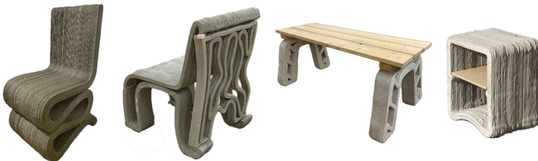
Abbildung 5: Vorversuche der additiven Fertigung von urbanen Gestaltungsobjekten
