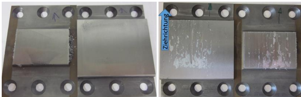
Abbildung 11. Reibbacken nach 7200 mm Ziehweg: (links) GJS700 (rechts) GJL200
