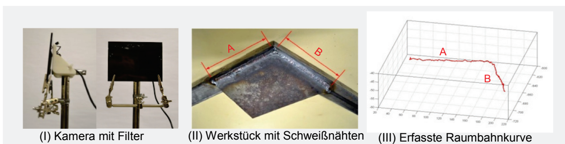
Abbildung 2. (I) Kamerakonfiguration mit Schweißschutzglas Schutzstufe 10, (II) Werkstück mit Schweißnähten, (III) Erfasste Raumbahnkurve.
