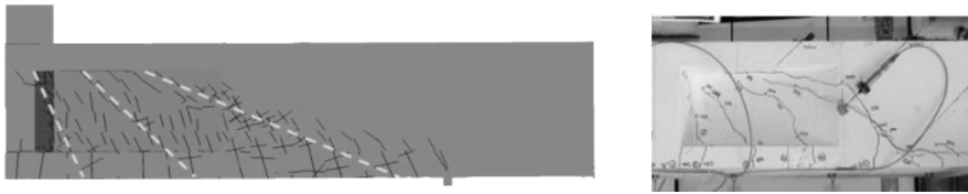
Abb. 8: Links: Rissbild beim Erreichen der Traglast; rechts: Rissbild im Versuch (Randl / Kunz 2009).
