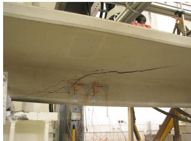
Abbildung 5. T-Träger nach dem Querkraftversagen
