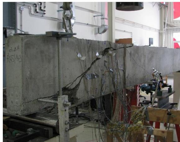
Abbildung 7. Rechteckträger nach dem Querkraftversagen
