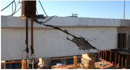
Abbildung 5: Versuchsaufbau „Melk“, links: maßgebender Schubriss nach Versagen, rechts: Versuchsaufbau
